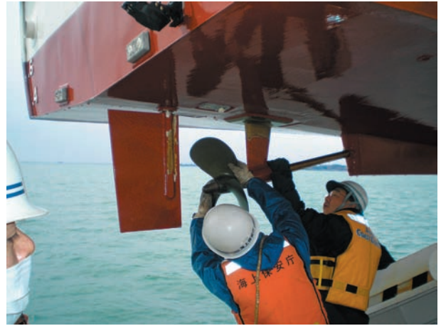
写真6 乗組員による絡索除去。 Photo 6 Crew removing a tangled rope.
