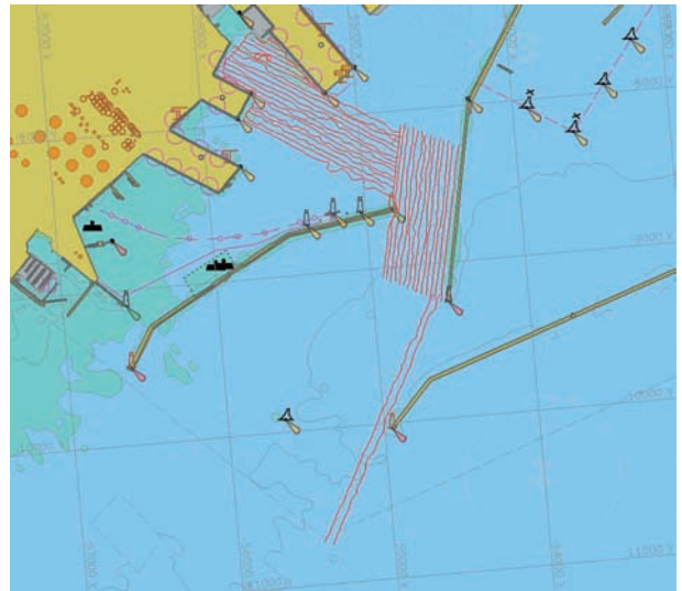
図 13 小名浜港における 3 月 26 日のインターフェロメトリ測深機を用いた調査の測線 (「明洋」搭載艇)。
