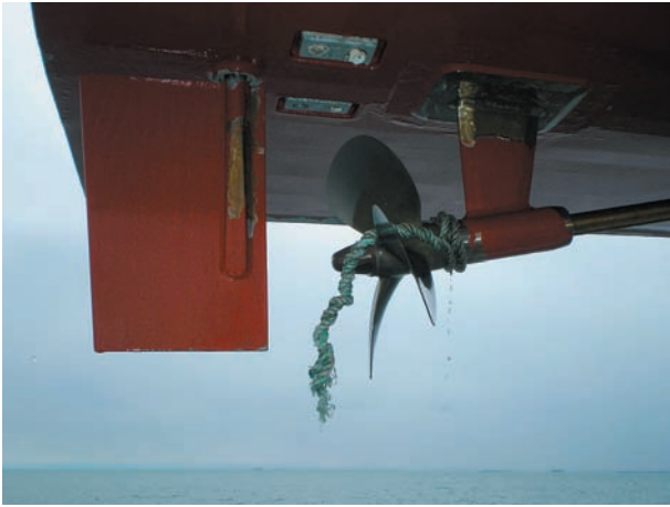
写真5 「じんべい」の推進器に絡まったロープ。 Photo 5 Rope tangled in propeller of the onboard craft, Jinbei .
