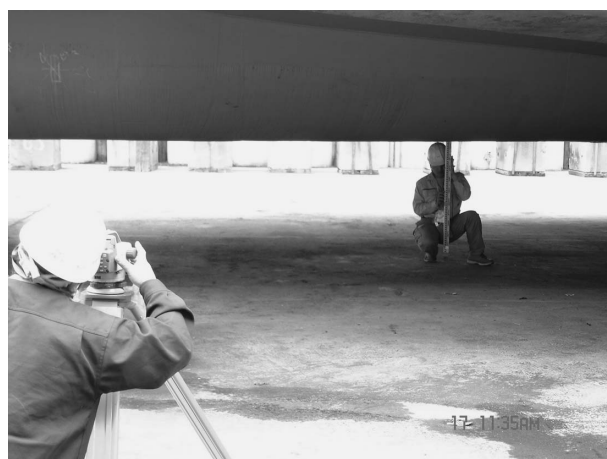
写真5 レベリング（トランスデューサ底面） Photo. 5 Leveling.
