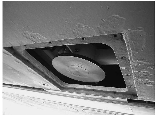
写真2 「明洋」船底へのトランスデューサ取付け状況
