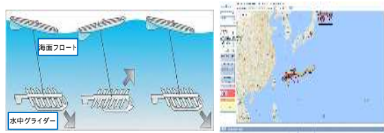
図1 AOV移動原理
