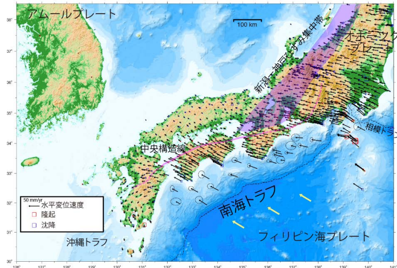
図1 南海トラフ沿いの水平地殻変動速度 (Nishimura et al., 2018). 陸海の地殻変動観測データを統合して表示した. 陸域 GNSS データの期間は 2005~2009 年. 海底 GPS-A のデータの期間は 2004-2012~2016 年.
