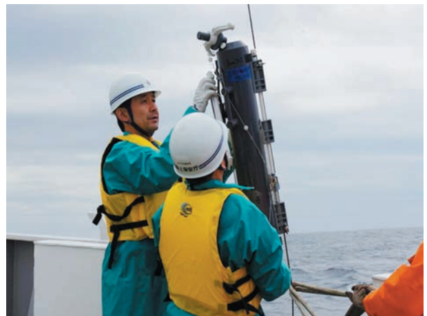
写真1 ニスキンX採水器による採水。 Photo 1 Sampling by using NISKIN-X SAMPLER.
